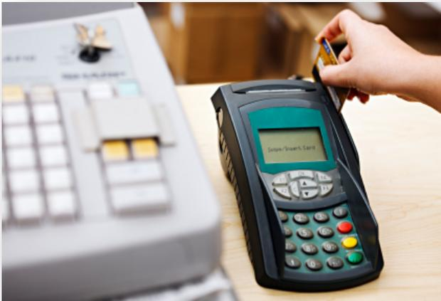
El manejo de un datáfono es sencillo, puesto que básicamente se trata de pasar o introducir la tarjeta en el dispositivo, indicar la cantidad con el teclado y enviar la compra al banco mediante una tecla.
